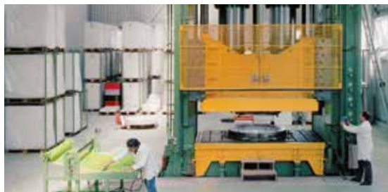
Unsere Fiberglaspresse (1750 Tonnen Druck) Notre presse à fibre de verre (pression de 1750 t) Our fibreglass press (pressure 1750 tonnes)
